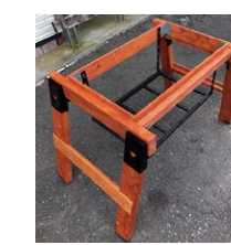
▲脚はH型にしっかり連結して、歪み無く同時に動くように調整します。
