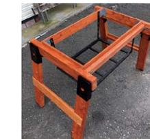
▲脚はH型にしっかり連結して、歪み無く同時に動くように調整します。
